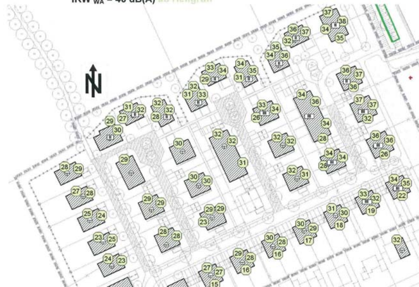
Abbildung 5 Immissionsbelastung in der Nacht durch die Sportanlagen (Vereinsgaststätte und Parkplatz) IRW WA = 40 dB(A) ab Hellgrün
