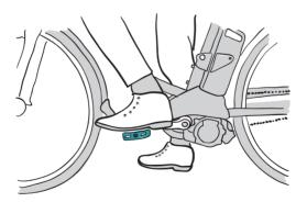
→ Tipp: Sollte Ihr Pedelec mit einer Anfahr-/Schiebehilfe ausgestattet sein, können Sie diesen kleinen Test zusätzlich in gleicher Weise durchführen, indem Sie den Schalter der Anfahrhilfe betätigen.
